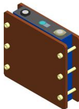
Fig. 4 Diagram of cell with clamp 图 4 电池上夹具图
